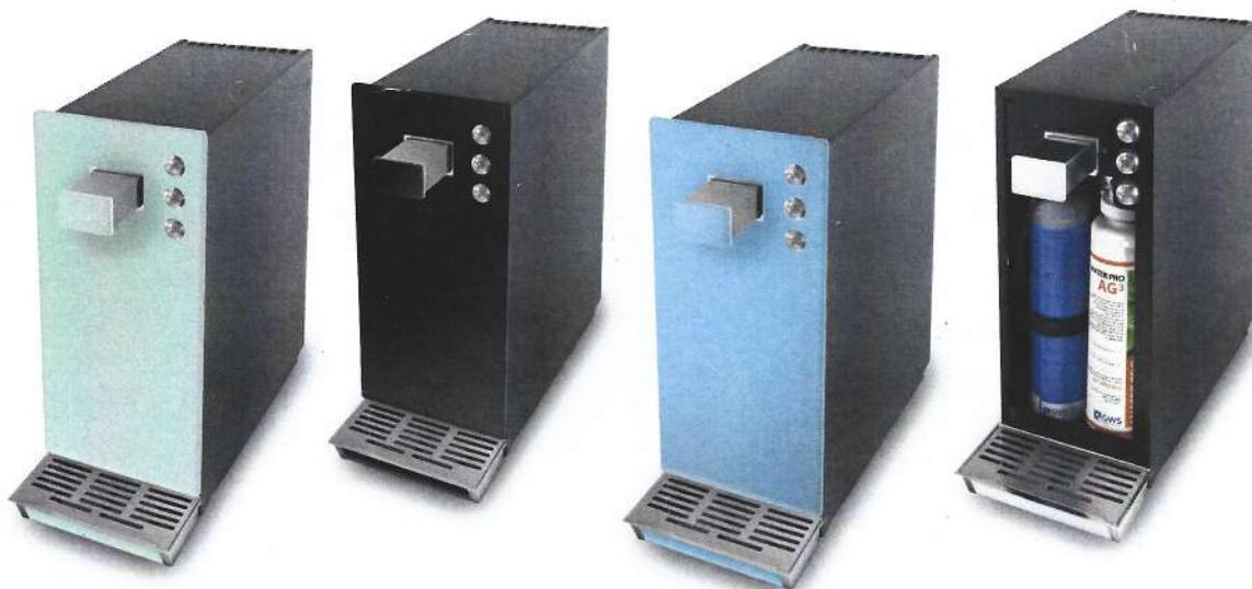
**Azzurra** è un erogatore destinato al settore domestico, dotato di tre pulsanti di erogazione per acqua liscia, fredda e fredda gassata. L'impianto è in grado di erogare acqua fresca o a temperatura ambiente, liscia o frizzante con una capacità produttiva di 12 litri/ora.
